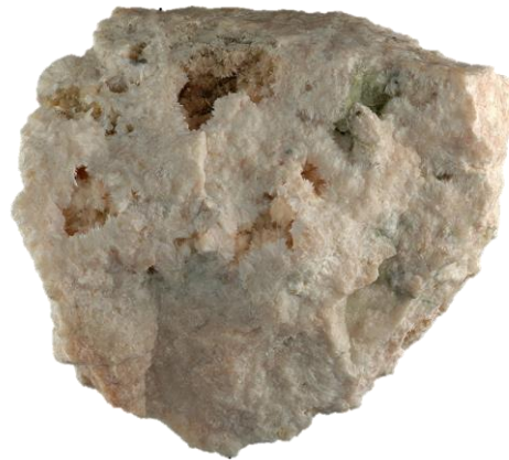
بوهمیت (Bohmite) - حاوی ۸۵٪ Al_2O_3 فرمول شیمیایی: \gamma-AlO(OH)
