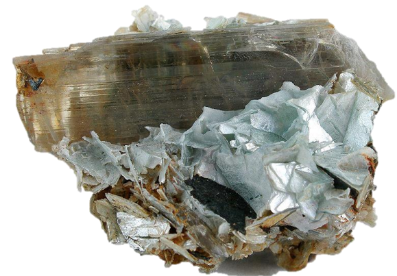
دیاسپور (Diaspore) - حاوی ۸۵٪ Al_2O_3 فرمول شیمیایی: \alpha-AlO(OH)
